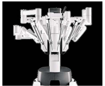
„DaVinci X“ ist ein vierarmiger OP-Roboter, der dem Arzt höchste chirurgische Präzision ermöglicht. Foto: Intuitive Surgical
